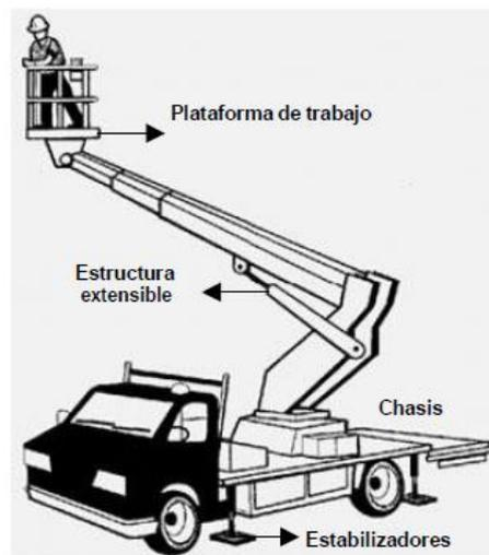
**Chasis:** Forma la base de la plataforma elevadora. Puede estar situado sobre el suelo, ruedas, cadenas, orugas o bases especiales. Se puede montar sobre remolque, semi-remolque, camión o furgón.
