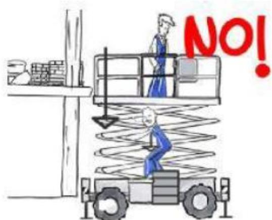
**6. Atropellos:** Se originan al arrancar el motor de plataforma sin que se haya inspeccionado previamente la presencia de trabajadores u otros elementos en el radio de acción de la plataforma o bien cuando la máquina queda fuera de control.
