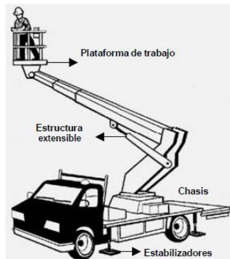
**Chasis:** Forma la base de la plataforma elevadora. Puede estar situado sobre el suelo, ruedas, cadenas, orugas o bases especiales. Se puede montar sobre remolque, semi-remolque, camión o furgón.
