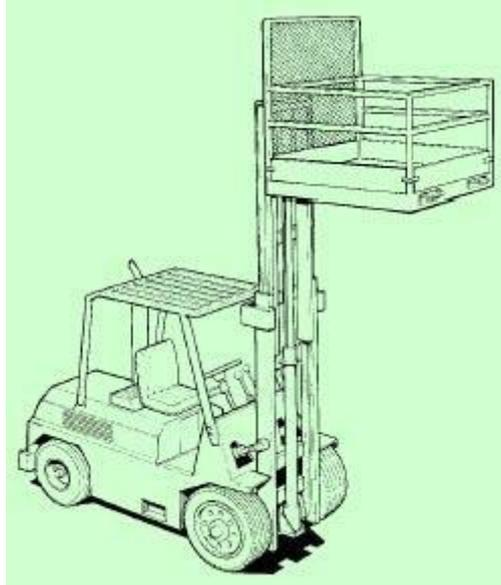
Figura 6: Vista general de un conjunto plataforma-carretilla elevadora
